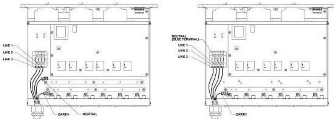
**Anschlussdiagramme für die Versionen mit einpoligen S-Automaten (links) und mit S-Automaten + Null-Abschaltung (rechts)**
